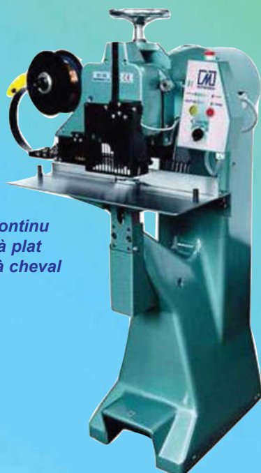
Agrafeuse de table 1 tête Agrafe jusqu'à 17 mm (papier normal 80 g/m²) Autre version : 2 têtes Agrafage à plat et à cheval Magasin 400 à 500 agrafes
