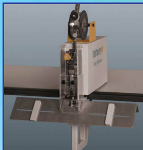
Piqueuse à fil continu de table jusqu'à 6 mm à plat Tête Hohner 43/6 S Pique à plat et à cheval En option agrafage bouclettes
