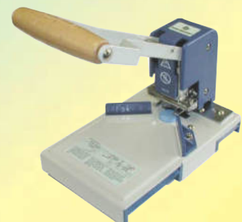
Coupe coins à levier pour petites séries Epaisseur maxi de coupe 10mm Equipé de : 3 outils coins ronds 1 couteau angle 45° 1 outil coup de pouce 1 poinçon Ø 6mm
