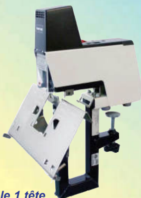
Agrafeuse de table 1 tête Agrafage à plat et à cheval Déclenchement par contact ou par pédale Agrafe jusqu'à 5 mm (papier normal 80 g/m²)
